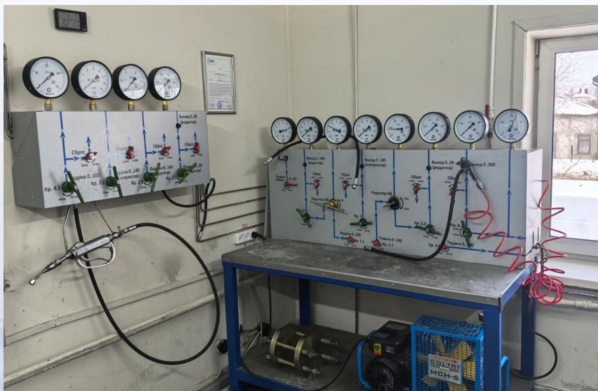
Узлы дозирования одоранта подвергаются гидравлическим и пневматическим испытаниям на аттестованном стенде
