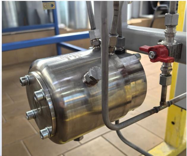
**Плунжерный насос подачи одоранта с пневмоприводом**
